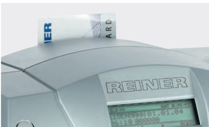
Identifikation des Bediener mit personalisierter Chipkarte.
