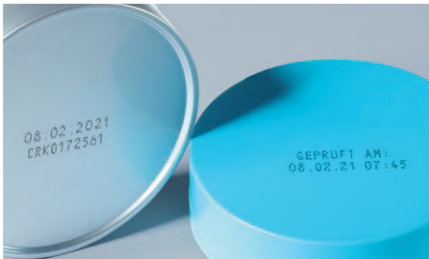
Bedrucken von Metall und Kunststoff mit schnelltrocknender Farbe (Ausführung MP).
