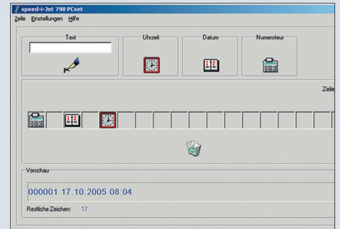
Die Software für den speed-i-Jet 798 erklärt sich von selbst: Text eingeben, Datum, Uhrzeit und fortlaufende Nummer definieren und per USB übertragen!
